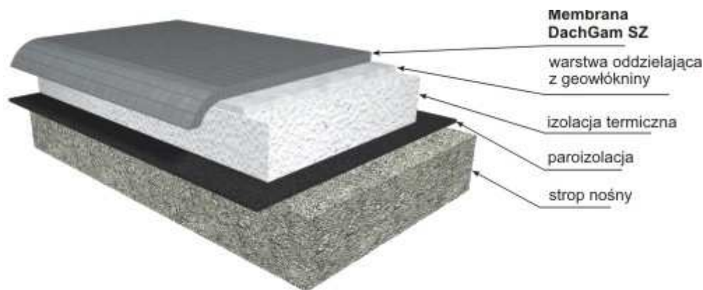
Rys. Warstwy dachu w systemie mechanicznego mocowania
