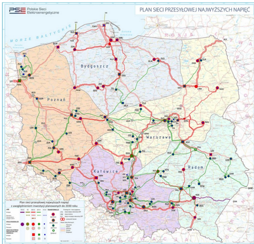
Rys. 7 Schemat Krajowego Systemu Przesyłowego (KSE)
